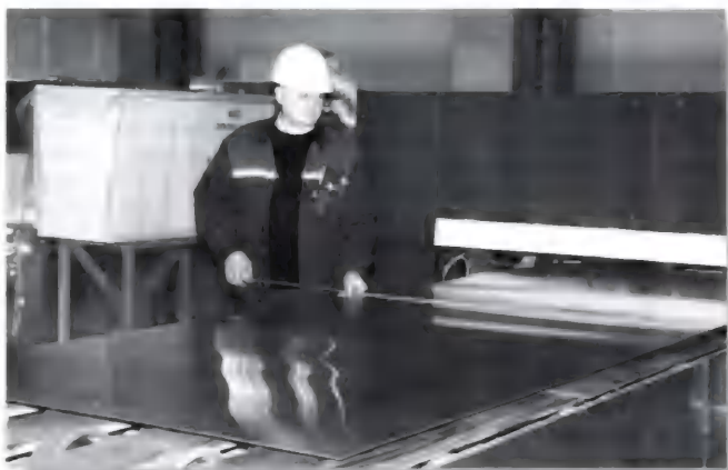
Готовые титановые листы с ультрамелкозернистой структурой из высокопрочного титанового сплава Ti6Al4V
